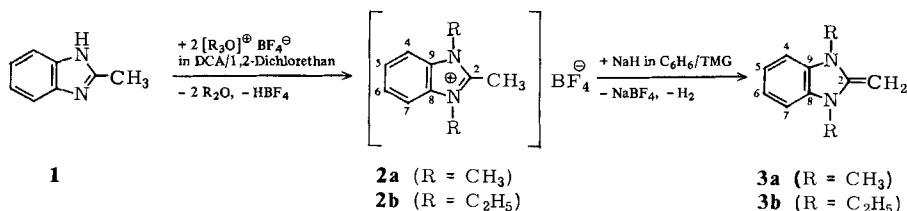
Alkylierung von 2-Methylbenzimidazol (**1**) mit Trialkyloxonium-tetrafluoroborat<sup>7,8)</sup> in 1,2-Dichlorethan in Gegenwart von *N,N*-Dicyclohexylethylamin (DCA) als nicht alkylierbarem Protonenabstraktor<sup>9)</sup> führt mit ca. 70–90proz. Ausbeute direkt zu den Benzimidazoliumsalzen **2**.
